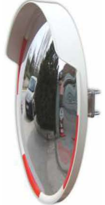
12229 RW Verkehrsspiegel rot-weiß, ø 60 cm Acrylglaspiegel, Beobachtungsabstand 0 - 15 m Rahmen: ABS, Gelenkarm: Aluminium, Gewicht: 4.0 kg
