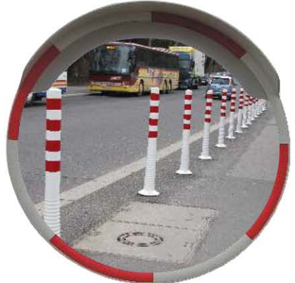
12229 RW Verkehrsspiegel rot-weiß, ø 60 cm Acrylglaspiegel, Beobachtungsabstand 0 - 15 m Rahmen: ABS, Gelenkarm: Aluminium, Gewicht: 4.0 kg
