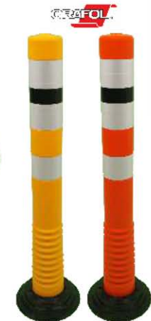
12230 KG Flexipfosten® gelb 12232 KO Flexipfosten® orange (H)750 mm, TPU, ø 80 mm, 1,46 kg retroreflektierende Streifen ORALITE® 5450 weiß Commercial Grade Class RA1 Design A Fuß ABS ø 200 mm zum Kleben
